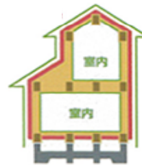
断熱材(外張り断熱)
